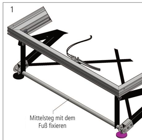
Greifen Sie mit einer Hand unter das Podest. Dort sitzt mittig der Bowdenzug. Für eine Höhenverstellung müssen Sie diesen Handgriff zu sich ziehen.
